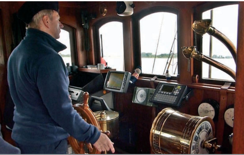
Kommandostand mit Ruder und Maschinentelegraph
